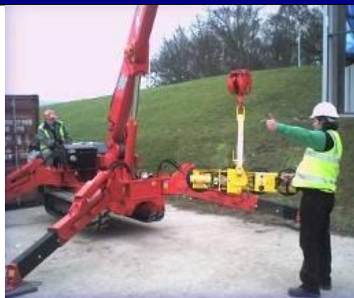
Chef de manœuvre indique les mouvements à l'opérateur
